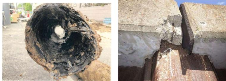
図4 老朽化した下水管(Zパイプ) 老朽化した雨水排水路
