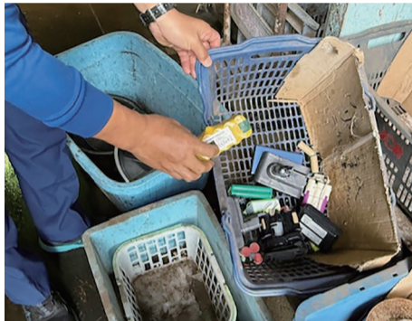
▲粗大ごみ破砕前に取り除いたバッテリー(破砕機に投入されると発火の原因になります)
