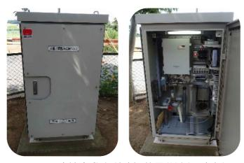
図 3-5.連続自動水質監視装置(外側・内部)
